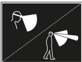
Ein breiter, homogener Lichtkegel für eine komfortable Sicht im unmittelbaren Nahbereich der Hände oder Füße und ein kombinierter Lichtkegel (breit und fokussiert) für die Sicht im unmittelbaren Umgebungsbereich und im Fernbereich bei der Fortbewegung.
