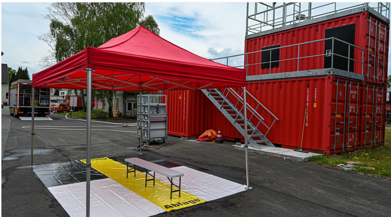
Planenset Einsatzstellen-Hygiene zur Kennzeichnung des Schwarz-Weiß-Bereiches mit integrierter Ablageplane für kontaminierte Ausrüstung und Geräte.
