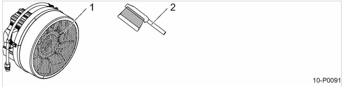
Abb. 13 Lüfterhaube reinigen
