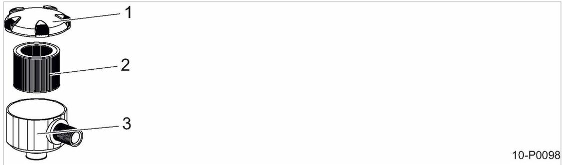
Abb. 16 Option H10: Luftfilter (mit Kunststoffgehäuse) warten
