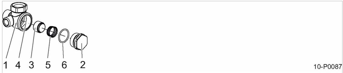
Abb. 23 Rückschlagventil reinigen
