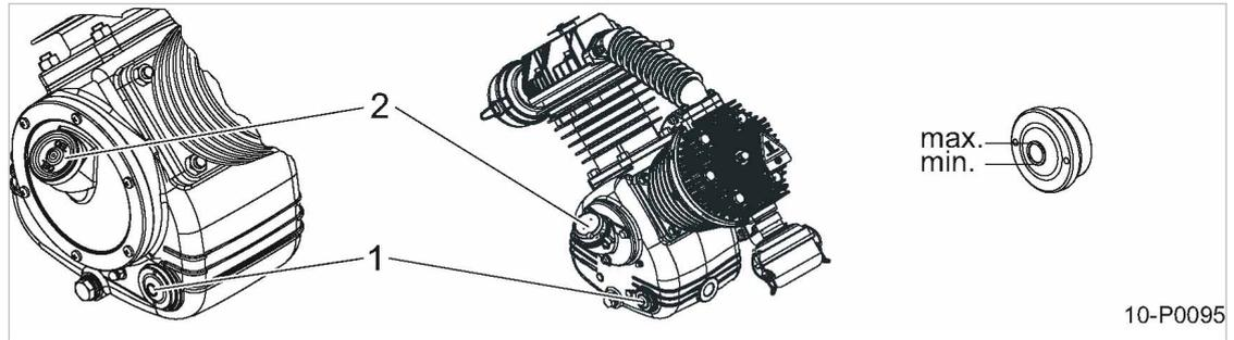
Abb. 17 Kompressorölstand prüfen
