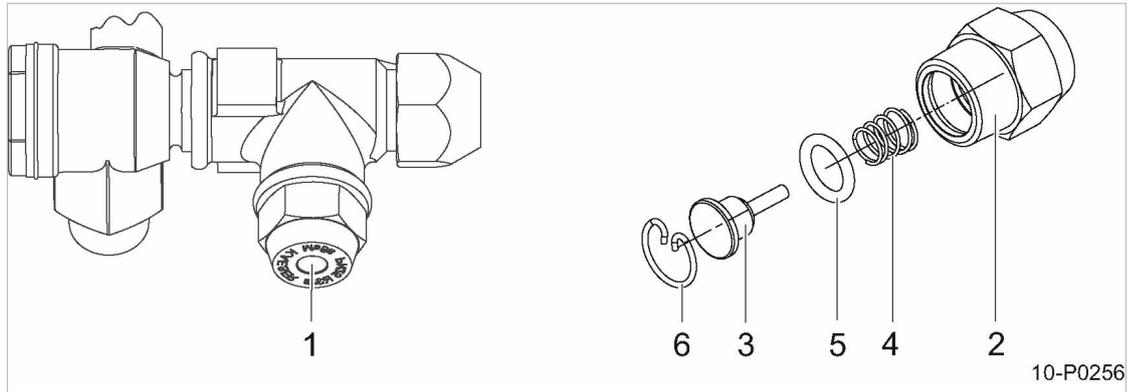
Abb. 25 Entlastungsventil am Druckluftbehälter warten
