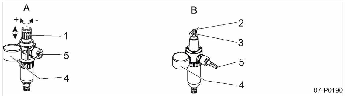
Abb. 11 Filterdruckminderer einstellen
