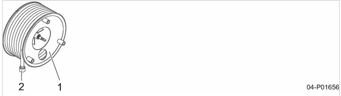
Abb. 5 Option P2: Schlauchaufroller
