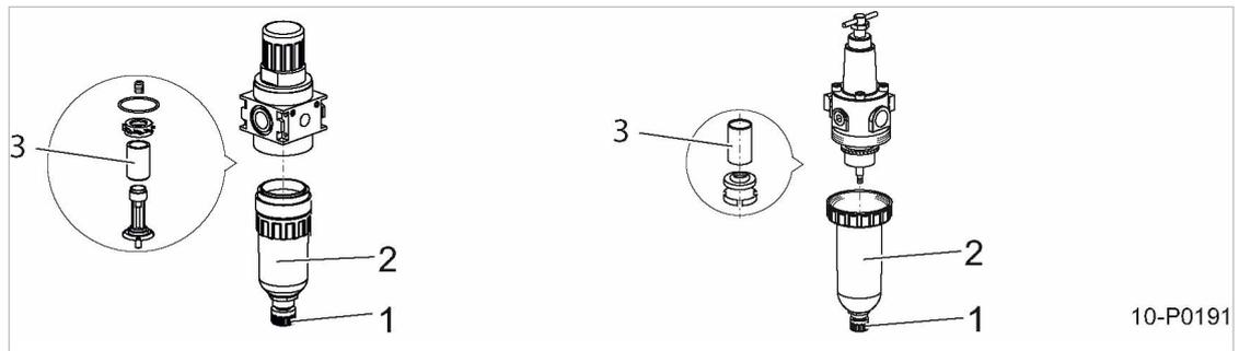
Abb. 26 Filterdruckminderer reinigen
