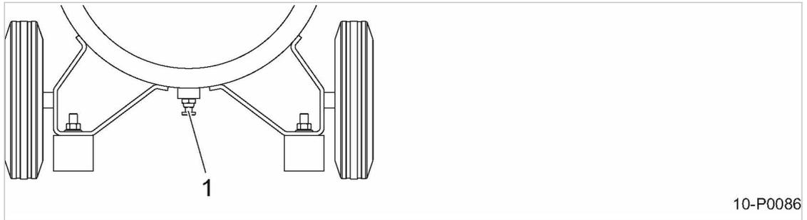
Abb. 22 Maschine entlüften
