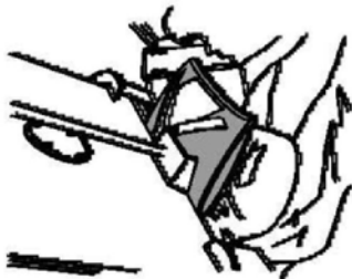
TÜR VON MAHLMASCHINEN ÖFFNEN, UM ARM EINES VERLETZTEN ZU BEFREIEN
